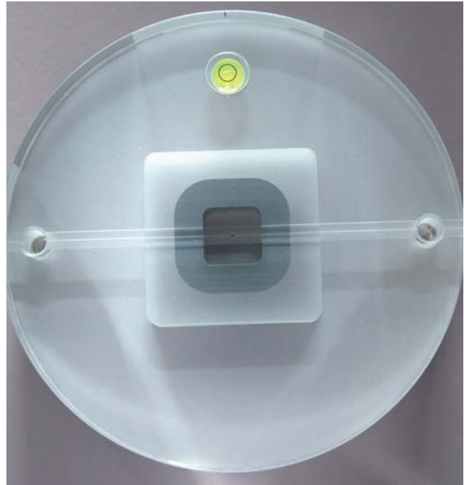
Abb. 4 Aufsicht auf den Prüfkörper gemäß der aktuell für alle digitalen Volumentomographie-Geräte in Deutschland gültigen DIN-Normen 6868-161 und 6868-15 zur Abnahme- und Konstanzprüfung. Für die Abnahmeprüfung werden zusätzlich Streukörper (aus Polymethylmetacrylat, PMMA) ober- und unterhalb der hier erkennbaren scheibenförmigen Struktur angebracht.
